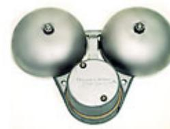
**Звуковой оповещатель** звонок громкого боя МЗМ представляет собой электромагнитный механизм переменного тока, заключенный в пылебрызгонепроницаемый корпус. Основными частями оповещателя звонок громкого боя МЗМ являются: основание, два колокола, крышка, катушка с магнитопроводом П-образной формы, коромысло с ударником и диод.
